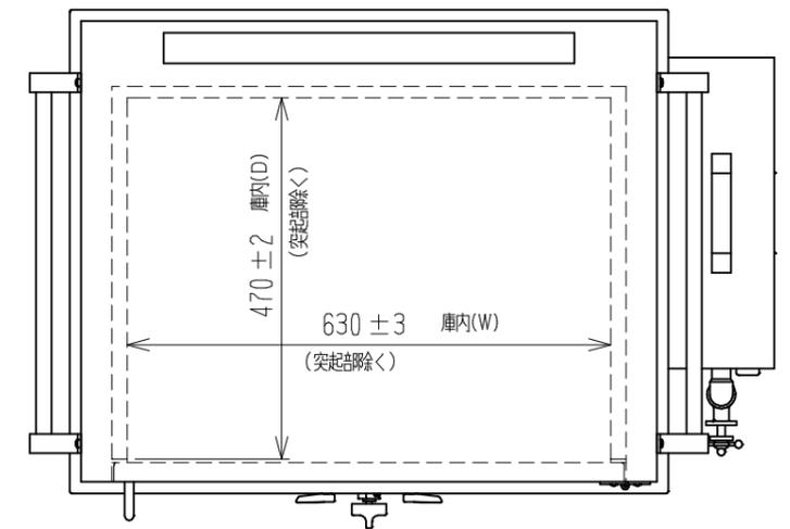
【平面図】 庫内有効パット寸法 (mm)
