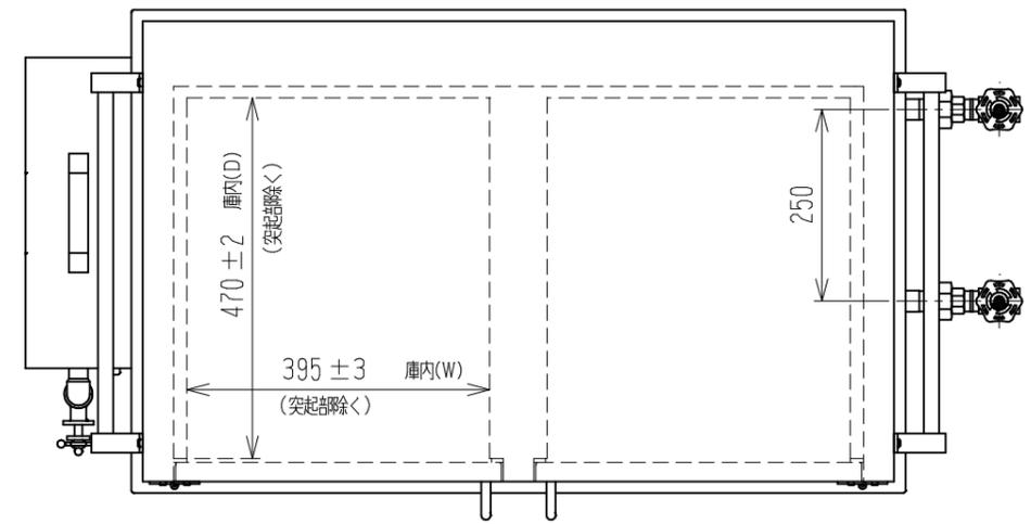
【平面図】 庫内有効パット寸法 (mm)
