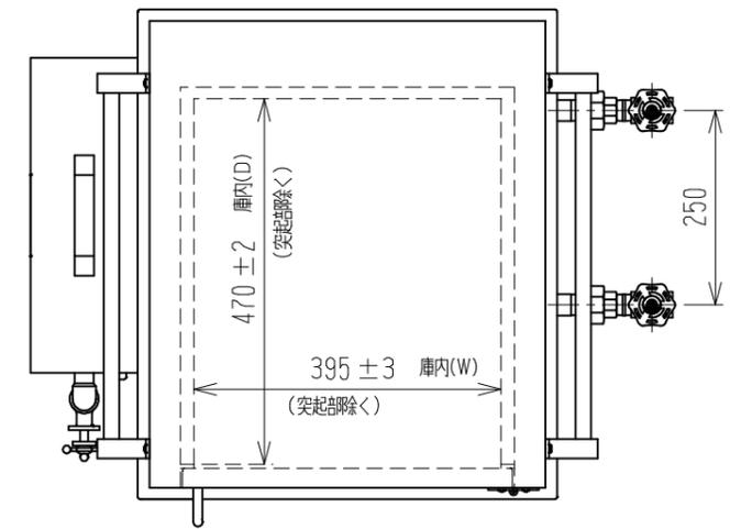
【平面図】 庫内有効パット寸法 (mm)
